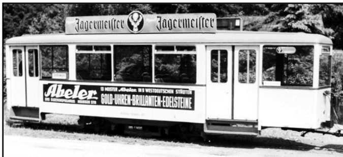
Beiwagen 4 IV (mit versetztem Hintereinstieg und Düwag-Falttüren nach Umbau zum Einrichtungswagen)
