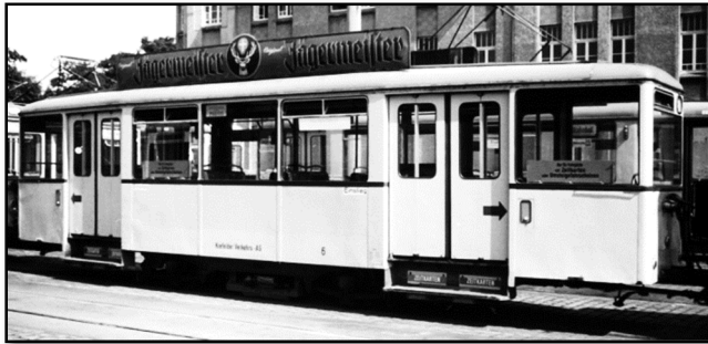
Beiwagen 6 (nach Umbau zum Mittelwagen des sog. "Steuerzuges" mit den Triebwagen 202 und 203)
