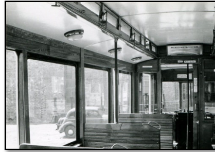
links die ursprüngliche Gestaltung der Innendecke mit vier einzelnen Glühlampen rechts Spätere Deckengestaltung mit weißer Resopalverkleidung und 8 Schalenleuchten
