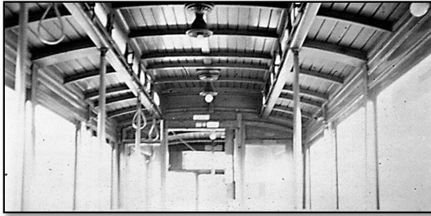
links die ursprüngliche Gestaltung der Innendecke mit vier einzelnen Glühlampen rechts Spätere Deckengestaltung mit weißer Resopalverkleidung und 8 Schalenleuchten
