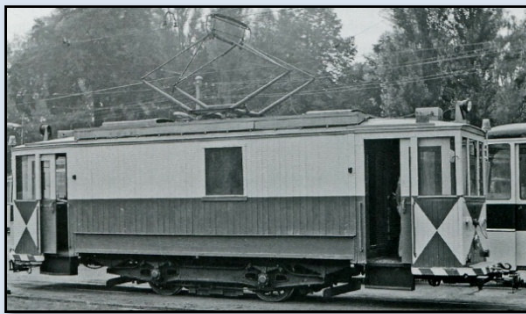
Atw A 92, vorher A 7 bzw. A 2, mit Holzaufbau und Schienenschleifeinrichtung, um 1975
