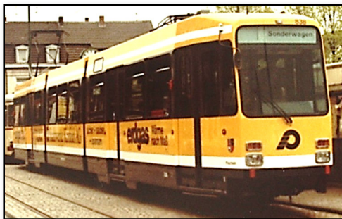
Außenansicht und Fahrerkabine des M8C 838 "Fischeln" im Jahr 1981. Es gibt noch keine Schürzen zur Kupplungsabdeckung.
