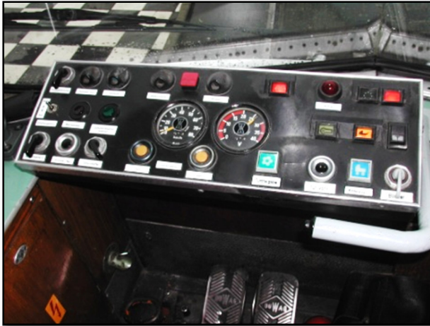
Tw 817, vorher 617: Armaturenbrett und Fahrscheindrucker, dahinter die Fahrwegcodierung
