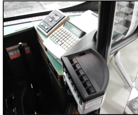
Tw 817, vorher 617: Armaturenbrett und Fahrscheindrucker, dahinter die Fahrwegcodierung
