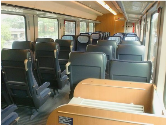
Modernisierungsprogramm IC mod: umgestalteter Großraum
